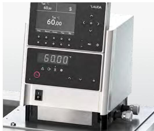
Abnehmbare Fernbedieneinheit für einfache und intuitive Bedienung
