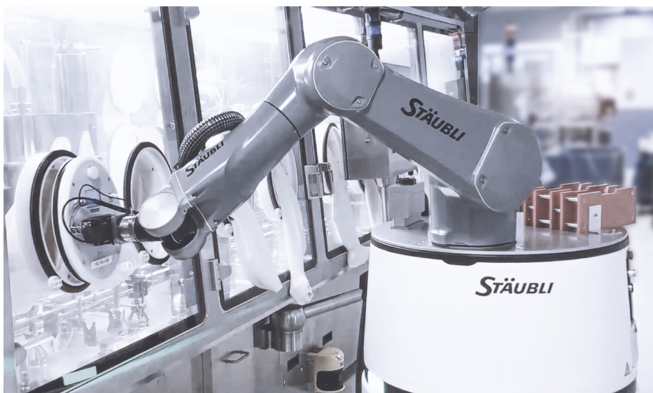
Ein autonomer mobiler Roboter prüft die Unversehrtheit von Isolierhandschuhen durch den Wechsel von Handschuhprüfgeräten in einer Geisterschicht
