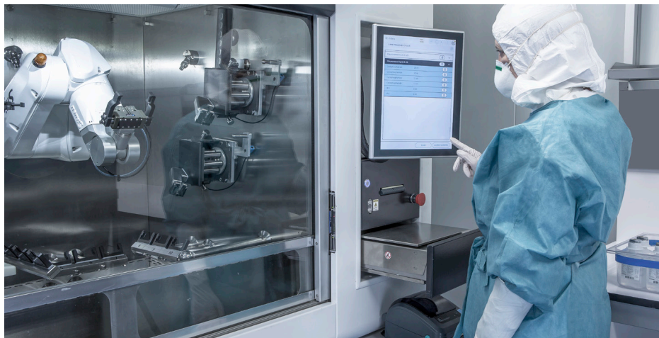
Robotic Compounding System für sterile Zubereitungen von gefährlichen Arzneimitteln.
