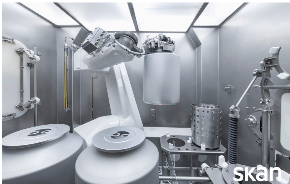
Ein RX160 Stericlean-Roboter bearbeitet den Wirkstoffbehälter in der API-Produktionszelle. Bild mit freundlicher Genehmigung der SKAN AG
