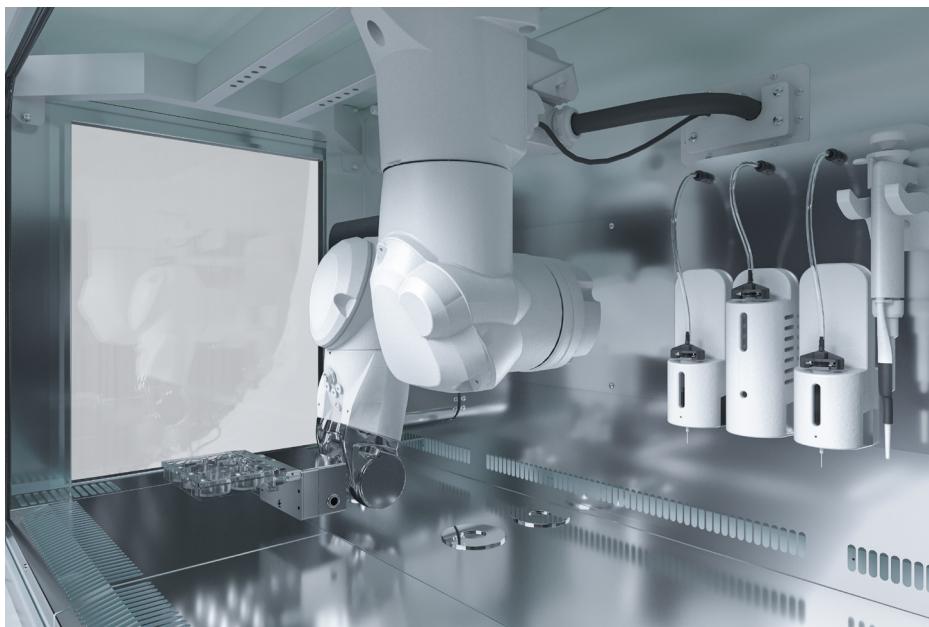
4D-Druck mit dem deckenmontierten TX2-40 Sechssachsroboter. ©Poietis
