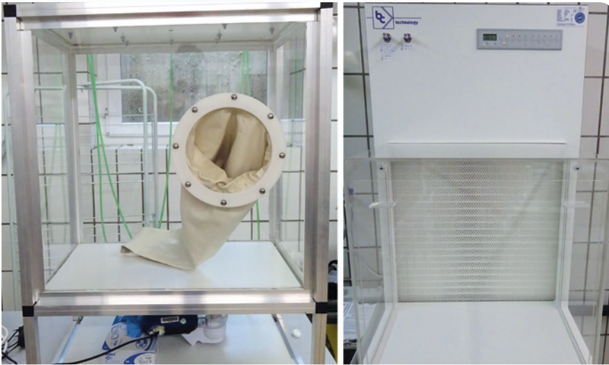
Abbildung 1: Prüfstand zur Nachstellung definierter Luftkeimgehalte (links) und Referenz-LAF-System (rechts) (Quelle aller Abbildungen: Hochschule Albstadt-Sigmaringen).
