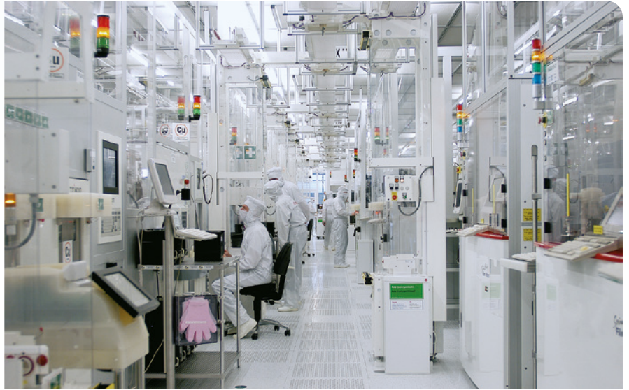
Abbildung 4: Reinraum mit voll automatisiertem Wafer-Transportsystem und gesamthafter Prozesskontrolle (Quelle: Infineon).
