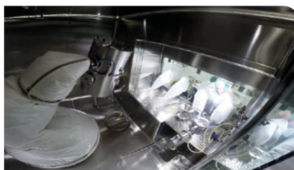
Abbildung 2: Isolator-Clusteranlage mit Sechssachsroboter. Vollautomatisierter Misch- und Nassreinigungsprozess in Zusammenarbeit von Mensch und Roboter (Quelle: Ortner).
