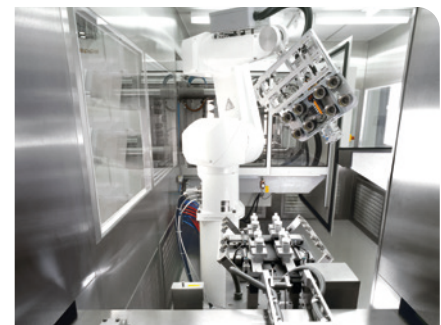
Abbildung 3: Vollautomatisierte Herstellung von hochreinen Trinksaugern für Baby-Milchflaschen (Quelle: MAPA).
